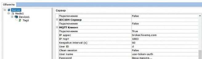
**Multi-Protocol Master OPC Server** – это модульный ОПС-сервер, предоставляющий возможности опроса устройств по различным протоколам (BACNet, Profinet, SNMP, счетчики энергоресурсов и др.). Кроме того, Multi-Protocol MasterOPC Server предоставляет возможность поддержки пользовательских протоколов на языке C++ или на встроенном скриптовом языке. Multi-Protocol MasterOPC Server может работать как OPC UA-сервер, OPC UA-клиент, а также как IEC 60870-5-104-сервер.
