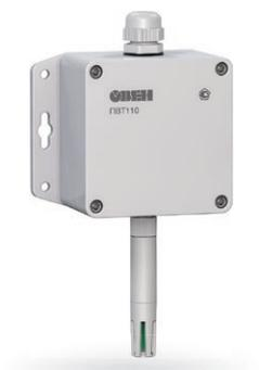
Промышленный датчик влажности и температуры ПВТ110 предназначен для непрерывного измерения относительной влажности (ОВ) и температуры воздуха или неагрессивного газа и преобразования измеренных значений в зависимости от модели прибора:
