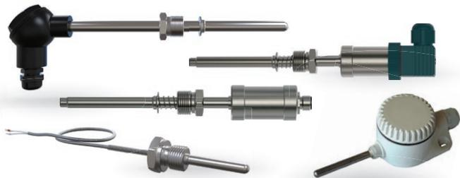
Принцип действия термопреобразователей сопротивления основан на свойстве проводника менять электрическое сопротивление пропорционально изменению температуры окружающей среды (ГОСТ Р 6651-2009). Конструктивно такие термопреобразователи выполняются в виде катушки из тонкой медной или платиновой проволоки на каркасе из изоляционного материала или используются тонкопленочные чувствительные элементы, заключенные в защитную гильзу.
