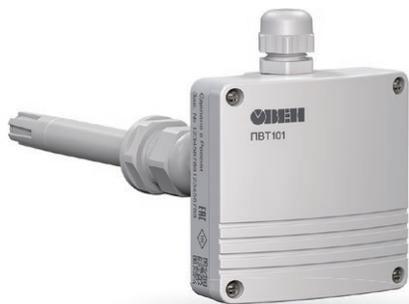
Предназначен для измерения значений относительной влажности и температуры неагрессивных газовых сред и преобразования в унифицированные аналоговые выходные сигналы тока 4...20 мА или напряжения 0...10 В – в зависимости от модификации прибора. Датчики применяются в системах ОВК (HVAC), ЖКХ – системах отопления, вентиляции и кондиционирования частных, общественных и производственных зданий.
