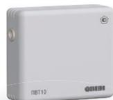
Датчики влажности и температуры ПВТ предназначены для непрерывного преобразования относительной влажности и температуры неагрессивного газа в два унифицированных выходных сигнала 4...20 мА и RS-485.
