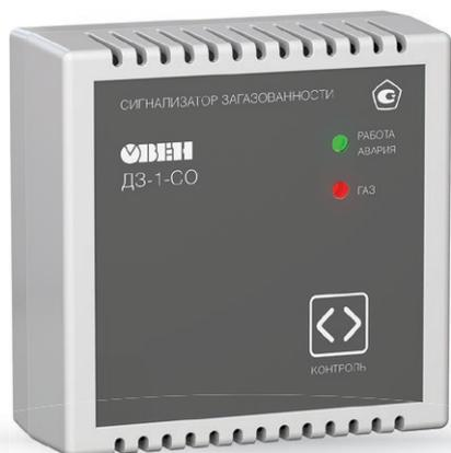
Прибор предназначен для непрерывного контроля концентрации окиси углерода (СО) и сигнализации о превышении установленных порогов концентрации в соответствии с требованиями РД 12-341-00 в воздушной среде котельных, подвалов и гаражей, жилых, административных, производственных зданий и сооружений. Прибор позволяет управлять сиреной, дополнительной световой сигнализацией, вентиляцией и т.п.
