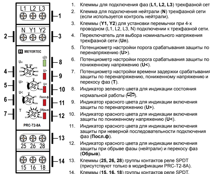
Рисунок 2 – Клеммы, управление и индикаторы прибора
